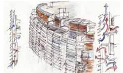
Detalle análisis y estrategia ventilación en Torre Agbar
